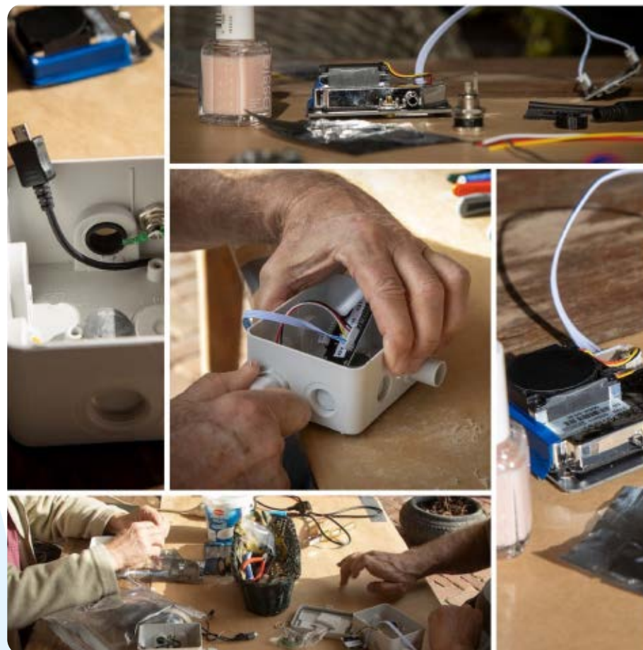
De werkgroepleden van SMM hebben het afgelopen jaar zo'n 140 meetsensoren gebouwd. Het bouwen van één sensor uit zo'n 25 aparte onderdelen duurt ongeveer 75 minuten. Fotografie: Jos Kaldenhoven
