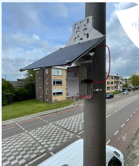
PM2.5 sensorbox met zonnepaneel.
